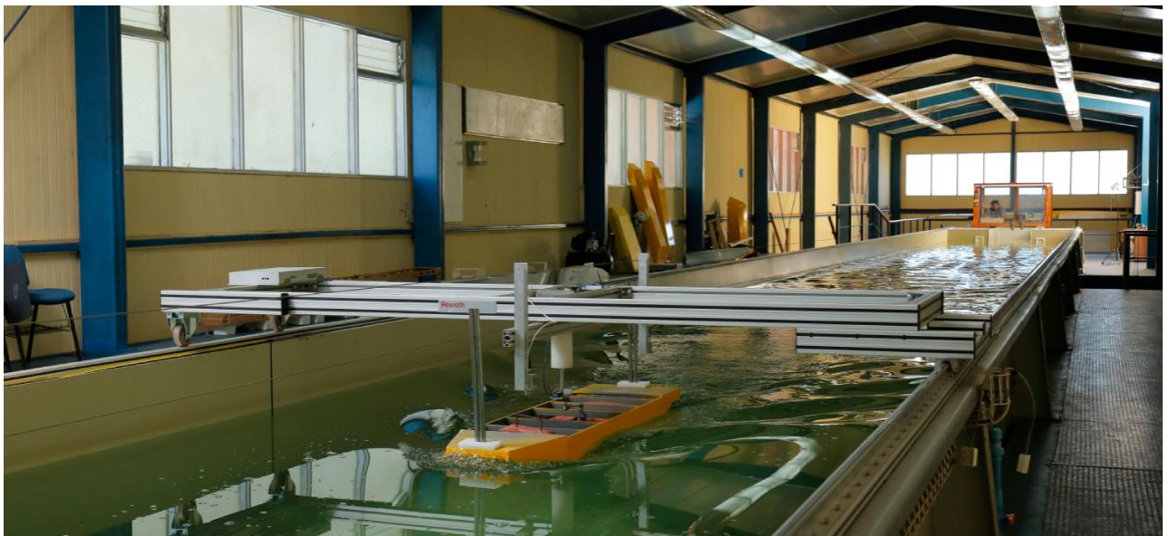
Fig. 01: Imagen Referencial – Canal de ensayo hidrodinámico
